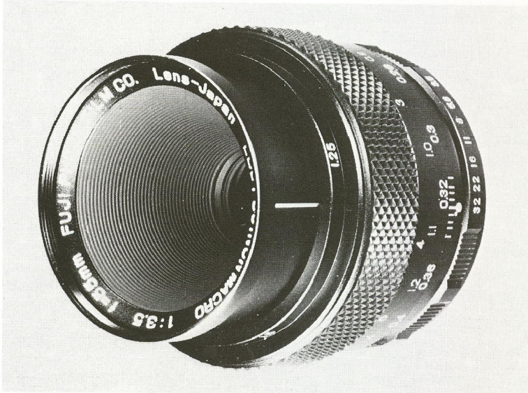
Fuji's makro-normaloptik 55 mm/f:3,5 med snekkeindstilling fra uendelig til afbildningsmålestok 1:2. Med en 27 mm mellemring udvides området til afbildning i naturlig størrelse 1:1.
